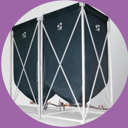
Silo para interiores y ambientes secos. Su estructura es metálica y el saco de poliéster tiene una alta resistencia. Su parte baja es de forma tronco-cónica y por el sistema de sustentación del saco, ángulo variable que facilita el vaciado total. Fondo de acero inoxidable con deflector interior y vibrador de extracción con intensidad regulable. Accesorios: turbocernedor y pesaje.
