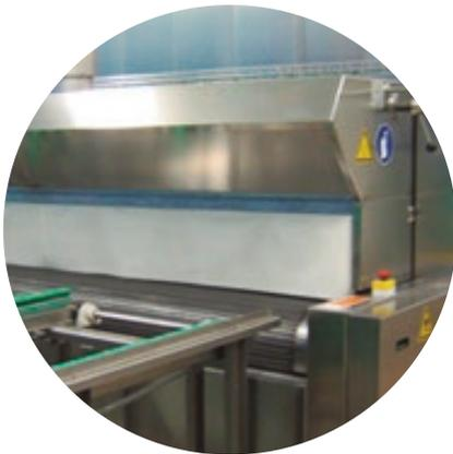
El **horno tunel** garantiza una reducción de los costes de producción y consigue una optimización de volúmenes y superficies ocupadas. Posee una mayor superficie de radiación al ser la superficie de forma ovalada.
