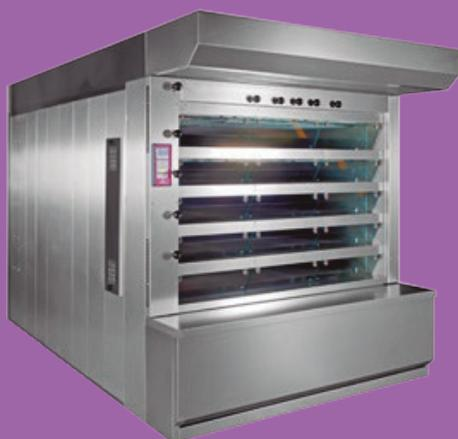
El **horno ciclotérmico de pisos** posee una gran ergonomía incluso con 5 pisos. Su altura de utilización es muy accesible, la solera más alta está a tan solo a 166 cm del suelo. La fabricación en serie le garantiza una relación óptima calidad-precio. Tiene fácil y accesible mantenimiento.
