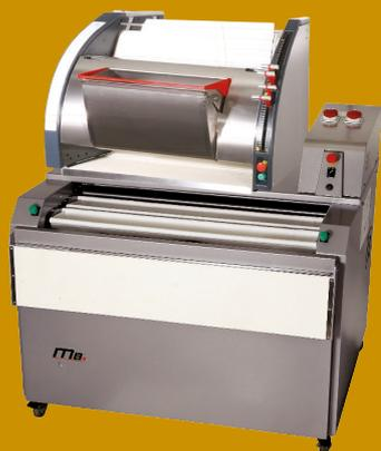
La **cámara de reposo** es de carga y descarga manual. Se asocia a una formadora vertical colocada encima, que permite que la masa repose después de la fase de división y antes de darle forma. Está especialmente diseñada para los artesanos preocupados en proporcionar un respeto óptimo para su masa. Consta de tres capacidades, su cubida se analiza con la capacidad de amasadera que usted tenga para optimizar su producción.
