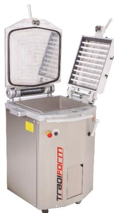
La Tradiform es la **divisora polivalente** de nuestra gama. División en cuba (cuchillas internas de 20 piezas, 10 opcional). Sistema de corte y formado exterior. Equipada con un sistema anti proyección de harinas, marco de parrilla de aluminio con tapa de seguridad de acero inoxidable, regulación de presión mediante acceso frontal y bisagra de la cubierta regulable en altura.
