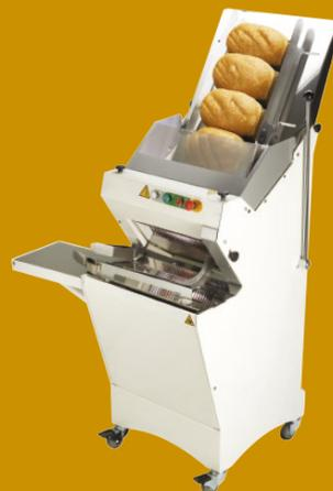
La Chute es una máquina ingeniosa dedicada al **corte continuo del pan de molde**. Construida sobre un principio de gravedad (el peso de los panes cargados crea una presión sobre las cuchillas), su rampa de carga puede acoger de 5 a 7 panes idénticos. Disponible en ancho de corte de 45 cm, equipada con una bandeja para migas ergonómica, puede recibir, opcionalmente, una sopladora de bolsas plegable para una mayor productividad.
