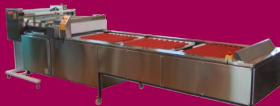
La **formadora doble** es un grupo múltiple para la formación de barras de pan y colocación de las mismas en las bandejas.
