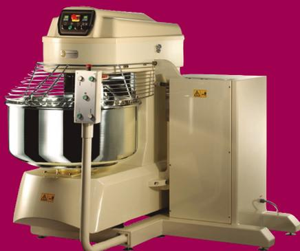
La **amasadora de espiral de volquete** encierra en una sola máquina la experiencia, la seguridad en el trabajo, el estilo en el diseño y la simplicidad de uso. Poseen una construcción sólida y son montadas en un sistema de levantamiento hidráulico. El utensilio en espiral, el pie central y la artesa son de acero inoxidable. El brazo de elevación con funcionamiento hidráulico para el ascenso y el descenso de la máquina es muy silencioso y no requiere lubricación ni mantenimiento.
