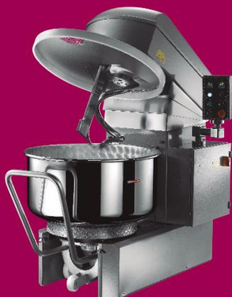
Amasadora de espiral con artesa extraíble específicamente proyectada para los trabajos intensivos de las industrias panaderas. Se fabrica con las tecnologías de fabricación más modernas; encierra en una sola máquina la experiencia, la seguridad en el trabajo, el estilo en el diseño y la simplicidad de uso.
