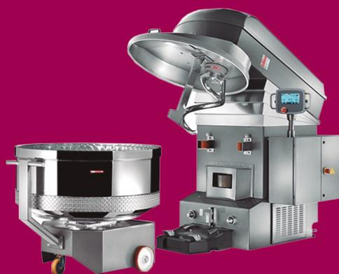
Amasadora de espiral con caldera extraíble. El bastidor de la máquina se realiza con carpintería de acero de gran espesor pintado en líquido (a pedido en acero inoxidable). El ascenso y descenso del cabezal y del enganche / desenganche del carro artesa son automatizados gracias a un circuito hidráulico que garantiza el perfecto bloqueo del cabezal y del carro. El cierre de la artesa durante la fase de trabajo evita la dispersión de polvos.
