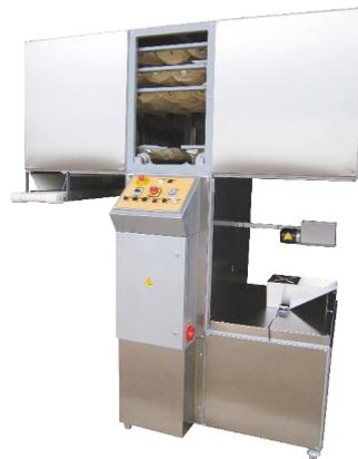
La **cámara** le da a las piezas el reposo necesario antes de su posterior formado. La máquina está diseñada para detectar automáticamente las piezas, recogiénolas mediante un sistema de guías y depositándolas en las bolsas. Una vez reposadas, son llevadas hasta la formadora mediante una cinta de salida.
